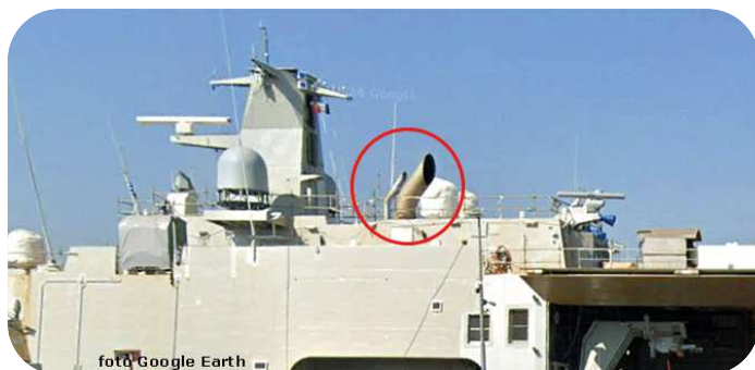
De uitlaat van de mijnenjagers op de Franse werf in Concarneau, de uitlaten zijn duidelijk anders dan deze die werden geleverd ...
