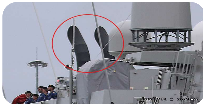
De uitlaat van de M941 bij zijn aankomst in Zeebrugge, de uitlaten zijn duidelijk anders dan de uitlaten op de scheepswerf in Concarneau ...
