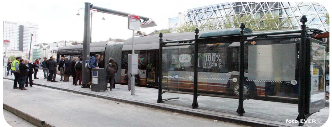
Een 100 % elektrische bus van de Lijn 64 aan het laadstation Naamsepoort die vanaf 29 april 2019 werd ingezet, het aan de bushalte opladen van de bus duurt maar enkele minuten en was een primeur voor België. Het project krijgt wel Europese steun uit het initiatief van het Benefic- project. Wij hebben nog vragen over de conformiteit van het laadstation met de regels van het AREI .
