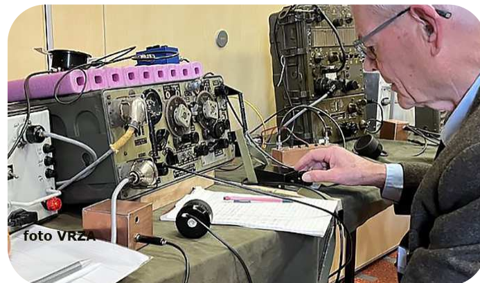
PA0CWF - Piet aan de morsesleutel en werkend met een Set WS 19 uit de 2e wereldoorlog, ON4CW staat op het logblad -foto VRZA-
