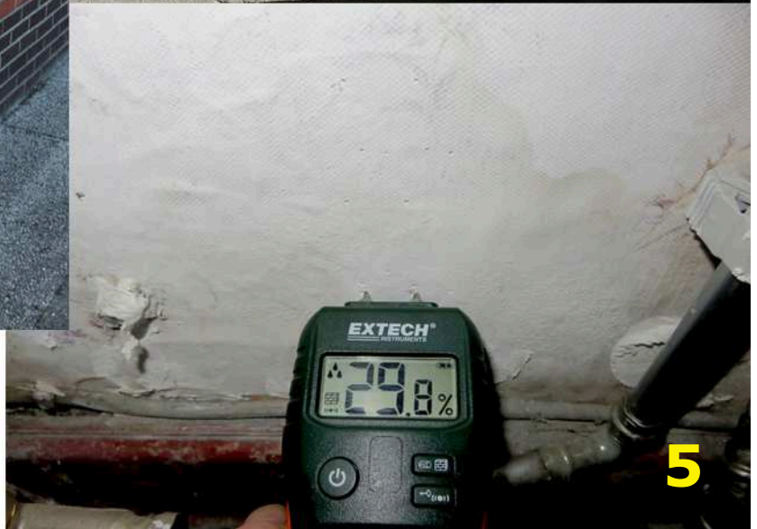
1. Dak binnenkoer - 2 Rolluik keuken - 3 Sierluisen / ramen buitenkant - 4 Scheur gevel slaapkamer 1 - 5 Vocht in muur slaapkamer en dat drie maanden na een behandeling tegen opstijgend vocht uitgevoerd door de eigenaar, een traiteur.
